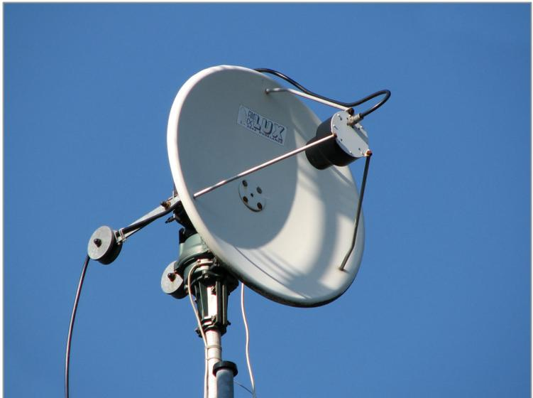
**Oben: Zirkularpolarisierter Feed mit Verstärker**
