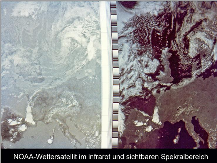
**Das empfangene NOAA-Wetterbild zeigt im linken Teil ein Infrarot-Bild, je dunkler, desto wärmer ist es. Im rechten Teil ist das visuelle Bild zu sehen. Z. Zt. (2013) ist der letzte analoge Wettersatellit (NOAA-19) in Betrieb, danach werden digitale Aussendungen von Wetterbildern auch auf 137 MHz genutzt.**
