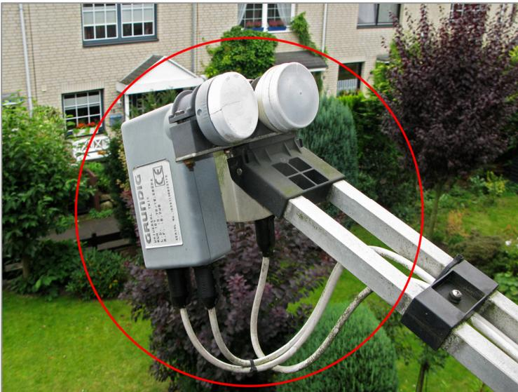
Verwendet wird ein 80cm-Spiegel, der an einem Rotor befestigt ist, der rechte LNB wird benutzt.
