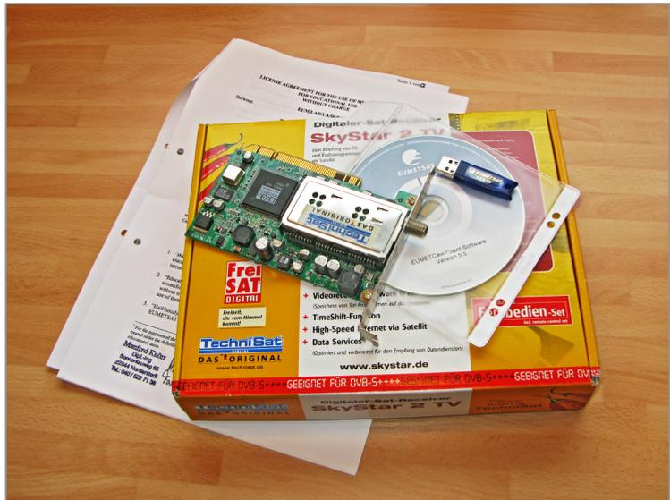
Die Abbildung zeigt das EUMETSAT-Antragspapier, die SAT-TV Karte „SkyStar 2“, die Software auf CD von EUMETSAT und den Dongle. Treiber und Einstellungen für die „SkyStar 2“ Karte sind auf der EUMETSAT-Software.
