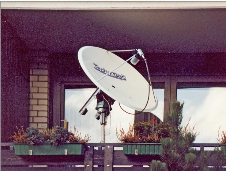
**Montage und Ausrichtung des Spiegels auf dem Balkon mit einem Horizontal – Vertikal Rotor.**
