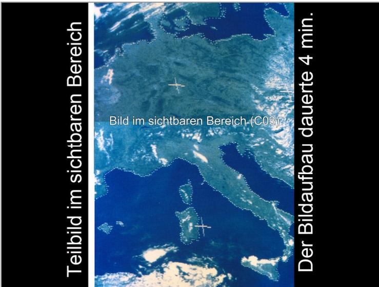
**Der Bildaufbau eines METEOSAT-Bildes dauerte knapp 4 Minuten und erfolgte zeilenweise.**
